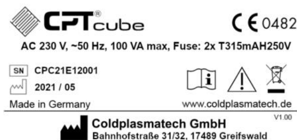
Abb. 4: Beispiel eines Typenschildes des CPTcube.
